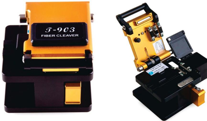
Clivador de alta precisão de três passos para efetuar a clivagem da fibra. Permite ajuste de ângulo para alta precisão, corte de fibras ópticas monomodo (SM) e multimodo (MM) de 125µm de diâmetro nominal e revestimento de 250µm e 900µm, com ângulo de  $90^\circ \pm 0,5^\circ$ , e comprimento entre 9 a 16mm. Lâmina circular substituível de 16 posições com vida útil de 8.000 clivagens.
